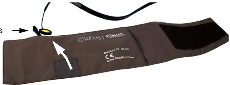
Schieben Sie das Mikrofon vorsichtig aus der Manschette und ziehen Sie den Druckschlauch vom Luftsack ab (Vierteldrehung des Steckers).
