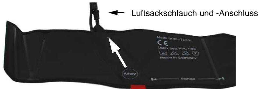
Schieben Sie das Mikrophon vorsichtig aus der Manschette und ziehen Sie den Druckschlauch vom Luftsack ab (Vierteldrehung des Steckers).
