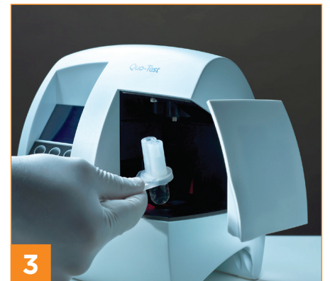
3 Kartusche im Analyzer platzieren. Anzeige des Messwertes innerhalb von 4 min.
