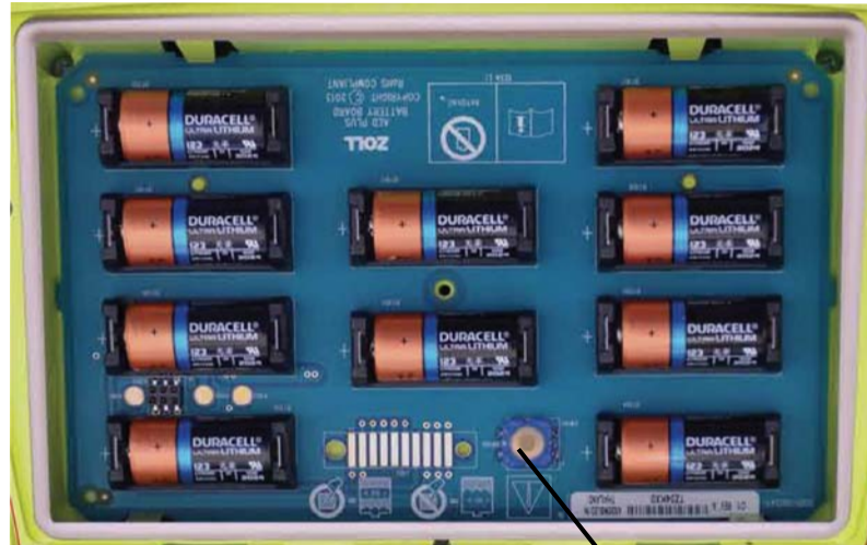
Reset-Taste der Batterie
