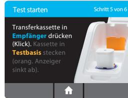
Sobald die Transferkassette korrekt am Probenempfänger angebracht ist, steigt der orangefarbene Indikator auf der Transferkassette nach oben. Sollte sich der orangefarbene Indikator nicht nach oben bewegen, auf den Probenempfänger drücken, bis sich der Indikator bewegt.
