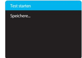
**⚠ Achtung:** Der Test wird erst gespeichert, wenn das vollständige Ergebnis angezeigt wird. Den Deckel nicht öffnen, bevor die Ergebnisse angezeigt werden.
