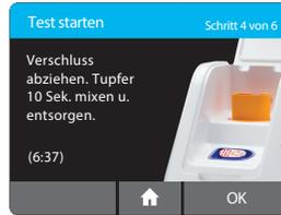
**Tupfer 10 Sekunden lang kräftig in der Flüssigkeit drehen.** Tupferspitze beim Drehen gegen den Rand des Probenempfängers drücken. Dadurch wird die Probe leichter vom Tupfer gelöst. Wenn die Probe vollständig gelöst wurde, „OK“ drücken, um fortzufahren.
