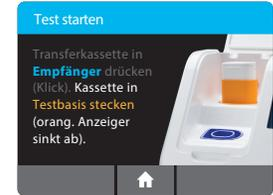
Sobald die Transferkassette korrekt an der Testbasis angebracht ist, sinkt der orangefarbene Indikator auf der Transferkassette nach unten. Sollte sich der orangefarbene Indikator nicht nach unten bewegen, auf die Testbasis drücken, bis sich der Indikator bewegt.
