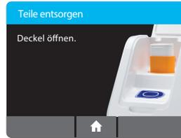
Entnehmen Sie die Teile, indem Sie die an der Testbasis angebrachte Transferkassette anheben und sie durch Drücken in den Probenempfänger im Probenempfänger einrasten lassen.
