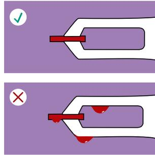
**Achtung!** Überprüfen Sie die Kapillare, ob diese vollständig gefüllt ist. **Den Probennehmer nicht abwischen!** Wenn sich zu viel Blutprobe auf dem Probennehmer befindet, entsorgen Sie den Probennehmer.
