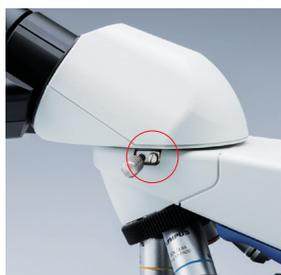
Sperrstift für einfaches Drehen des Binokulars
