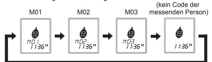
3. Wählen Sie einen Code der messenden Person und führen Sie den Test durch. Nach dem Test werden das Testdatum und der Code der messenden Person abwechselnd angezeigt.
